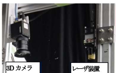
3Dカメラ レーザ装置 車両搭載型路面横断プロファイラの構成
